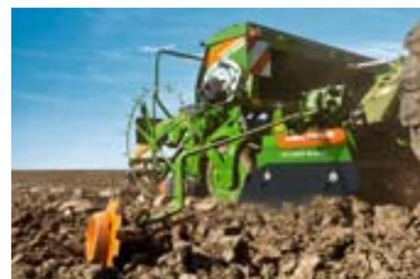
Une combinaison d'outils universelle capable de tout faire pour le semis après labour et le semis mulch : cultivateur rotatif Cultimix, rouleau rayonneur Matrix, AD avec socs RoTeC-Control.
