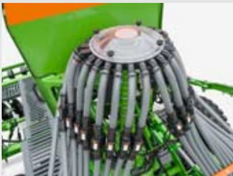
La tête de distribution segmentée permet de réaliser des jalonnages asymétriques d'un côté de la machine, sans réduction indésirable de la densité de semis sur l'autre moitié de la machine. La tête de distribution segmentée permet une coupure électrique unilatérale et Section Control.
