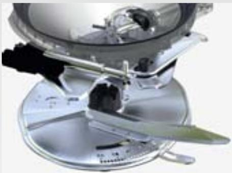
Le système d'épandage ultra moderne du ZA-V atteint, grâce à sa grande ouverture de trappe, un débit maxi de 390 kg/min. Le cône de fond de trémie qui débouche directement dans l'ouverture de trappe évite les reliquats et facilite le nettoyage.
