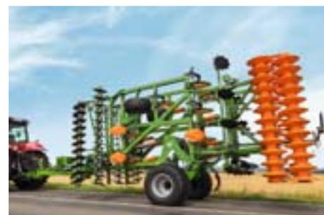
Le train de roulement TX logé à l'intérieur du Ceus-2TX permet une maniabilité élevée en tournière et un déplacement routier confortable. En fonction des restrictions nationales, une homologation 40 km/h est possible pour le Ceus-2TX pour des déplacements routiers rapides.
