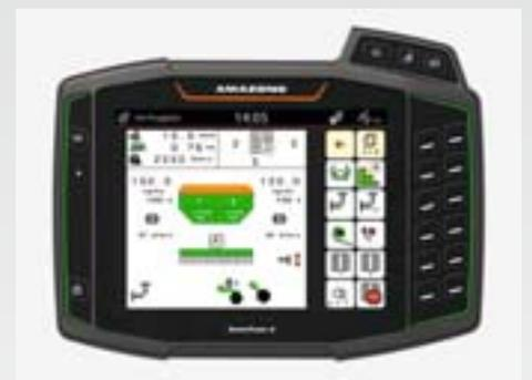
L'AD-P peut être piloté avec les terminaux ISOBUS AmaTron 4 et AmaPad 2 ou avec n'importe quel terminal à capacité ISOBUS. Il est ainsi possible d'équiper l'AD-P avec la coupe automatique GPS-Switch en tournière.
