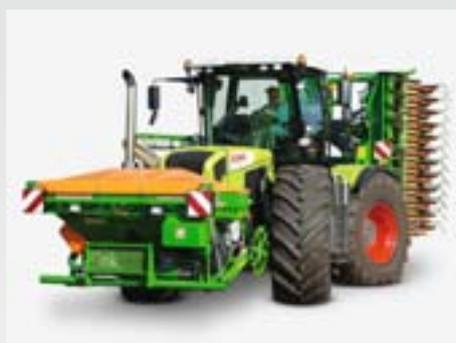
Comme la trémie de semence portée à l'avant est particulièrement plate et large, la visibilité vers l'avant reste dégagée. Cela vaut également pour la visibilité vers l'arrière sur la machine portée.
