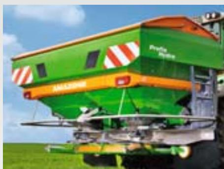
L'arceau de sécurité périphérique satisfait aux réglementations en matière de sécurité sur les ZA-V et ZA-TS. Les grandes plaques de signalisation ainsi que le système d'éclairage assurent une meilleure identification sur route.
