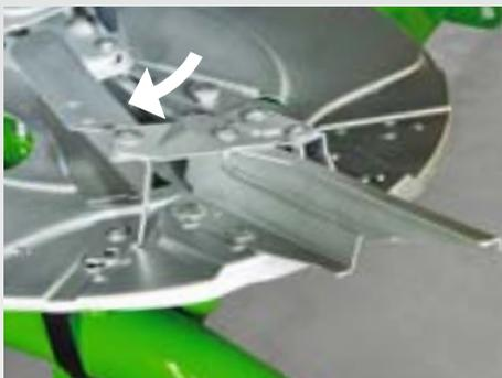
L'organe d'épandage TS avec système de bordure à commande électromécanique intégré AutoTS: pour l'épandage normal et en limite, des aubes d'épandage différentes sont activées sur le disque d'épandage. Excellentes courbes d'épandage en bordure sans changer de disque – télécommandées depuis la cabine du tracteur en cours de travail et sans arrêter l'épandeur.
