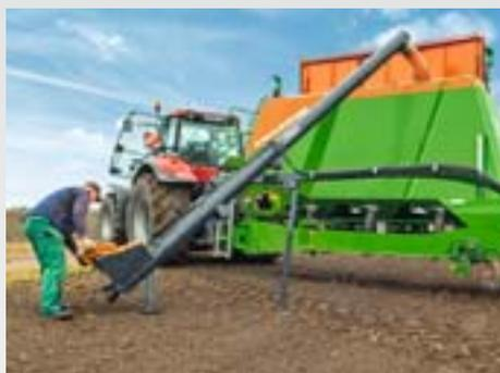
La vis de remplissage TAM pour les semoirs grande culture Citan et les semoirs à dents Condor est pilotée facilement par l'unité de commande sur la machine. Les dimensions au transport restent à une hauteur inférieure à 4 m et à une largeur inférieure à 3 m.
