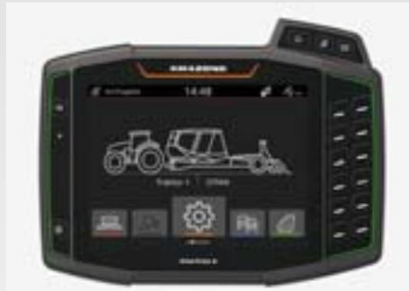
Avec l'entraînement de dosage électrique en option, associé à la commande et à la documentation ISOBUS, tous les moteurs de dosage peuvent être étalonnés indépendamment les uns des autres et pilotés durant le déplacement.
