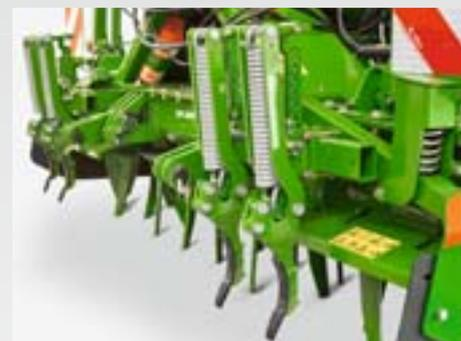
En option sur les herse rotatives et les cultivateurs rotatifs, le sol dans la zone des roues du tracteur peut être ameubli grâce aux efface-traces réglables en hauteur et latéralement. Afin de les protéger des dommages, les efface-traces sont dotés d'une sécurité de surcharge à ressort ne nécessitant aucun entretien.
