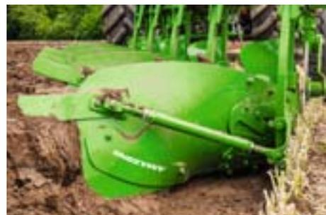
L'élargisseur de raie X-Blade est un agrandissement spécial monté sur le versoir du dernier corps. Le X-Blade crée un dégagement de la raie de labour en moyenne 30% plus large.
