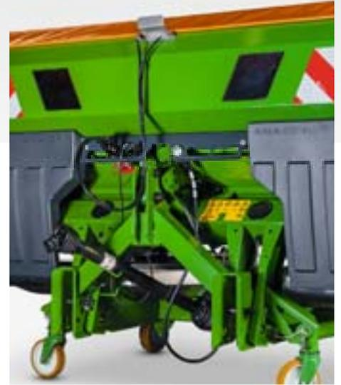
Le système de pesée offre confort et sécurité pour le respect de la dose voulue. En réalisant 200 pesées par seconde, il mesure en continu les variations d'écoulement de l'engrais. Il compare automatiquement la quantité réellement épanchée avec celle souhaitée.
