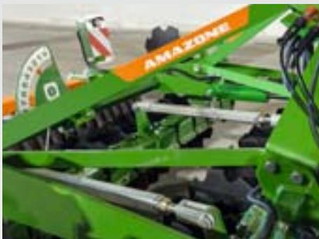
Le réglage de la profondeur de travail du compartiment de disques peut se faire au choix mécaniquement ou hydrauliquement pour plus de confort durant le travail et depuis la cabine du tracteur.
