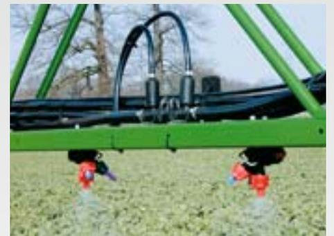
Le système de circulation continue (DUS) assure une concentration toujours constante de la bouillie jusqu'à la buse pour tous les pulvérisateurs AMAZONE. Lors du rinçage, l'eau claire va jusqu'aux buses.
