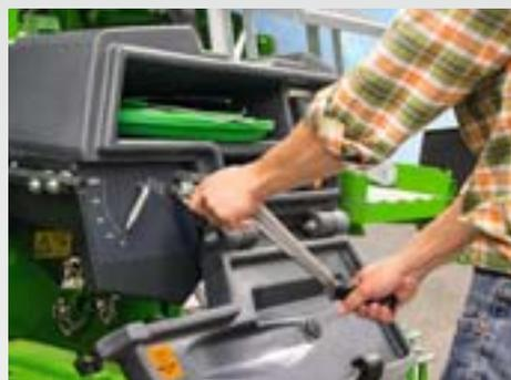
La pression d'enterrage de soc sur le TwinTeC et la profondeur d'implantation de semence sont réglées indépendamment sur le SmartCenter. Grâce à l'utilisation d'un outil universel, ces réglages centraux sont également rapides et simples.
