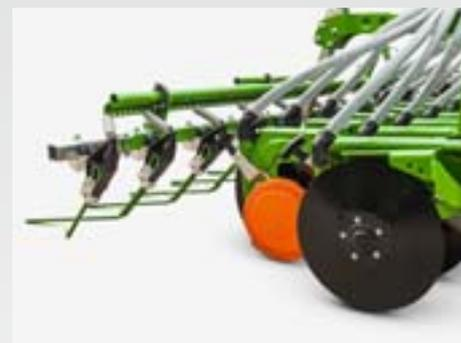
Le soc RoTeC pro Control permet de semer à des vitesses maximales, quelles que soient les caractéristiques du sol et les conditions météorologiques. La profondeur de semis est réglée hydrauliquement, rapidement et confortablement par le biais de la pression d'enterrage des socs. Pour les semis profonds, le système de réglage sur le soc peut être ajusté avec précision.
