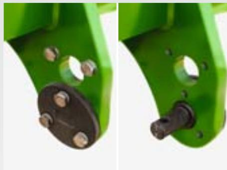
Pour l'attelage au tracteur, les bras inférieurs sont accouplés par des axes de catégorie 3. Toutefois une simple modification de la position de vissage du tourillon de bras inférieurs permet d'obtenir au choix la Cat. 3 ou la Cat. 2.
