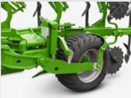
Une roue grand volume assure un entraînement optimal et un guidage en profondeur précis, même dans des conditions difficiles. La suspension hydropneumatique de série de la roue assure une sécurité maximale et un confort de conduite exceptionnel durant les déplacements routiers.
