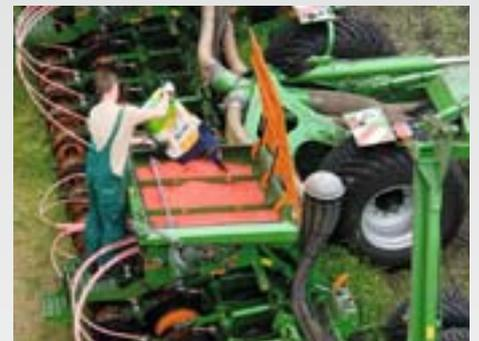
Pour une largeur de travail de 9 m, il suffit de remplir 2 trémies de semences. La centralisation permet de réduire les durées de remplissage et de réglage et entraîne une augmentation du débit de chantier.
