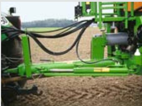
Un timon articulé, universel, pour piton d'attelage ou pour chape d'attelage avec rattrapage hydraulique permet de ne pas abîmer le sol, car il ne laisse pas de traces. Un système de freinage est disponible sur demande.
