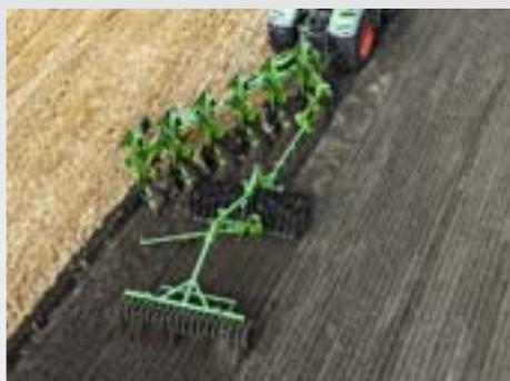
Le C-Pack 900 est un rouleau simple, composé d'anneaux de 900 mm de diamètre. Le profilé d'anneau de 36° permet une utilisation universelle sur différents sols.
