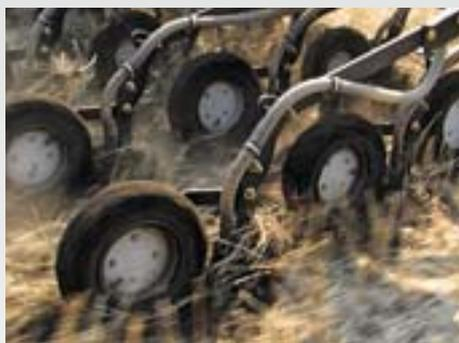
Le soc ConTeC pro se caractérise par une adaptation précise, verticale aux inégalités du sol, grâce à la roue Packer en aval. L'écart entre les socs, la structure 3 rangs et la hauteur de cadre assurent un travail sans risque de bourrage.
