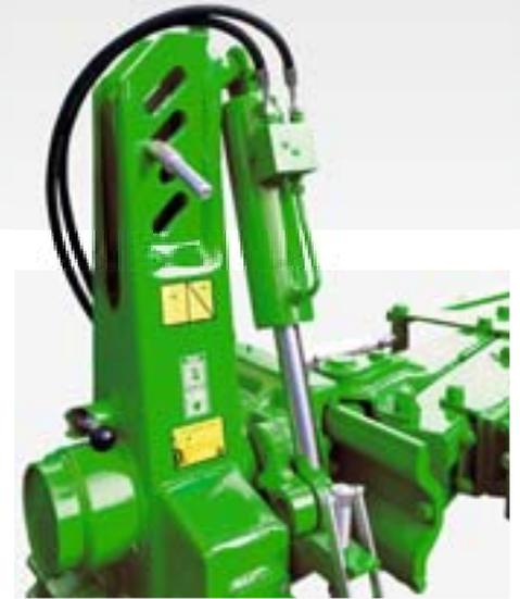
Tous les dispositifs de retournement des charrues Cayros disposent d'une réversibilité par le biais d'un vérin double effet avec commutation automatique. De ce fait le retournement de la charrue se fait en douceur et sans à-coups, par ailleurs la rotation de la charrue peut aussi être assurée par un distributeur simple effet avec retour libre. Les passages de flexibles bien étudiés permettent d'éviter tout risque de détérioration.
