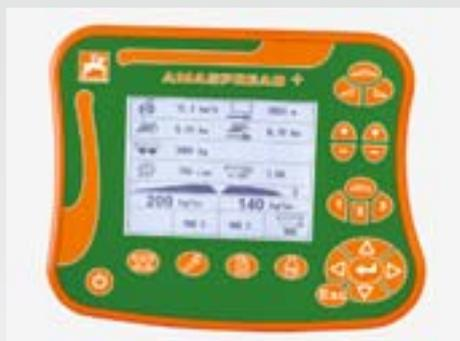
L'ordinateur de commande AmaSpread+ assure une régulation du débit dépendante de la vitesse d'avancement. Il pilote le dispositif de bordure Limiter V+. Un simple appui sur un bouton permet de passer de l'épandage normal, à celui en bordure, en limite ou en bordure de fossé depuis la cabine du tracteur.
