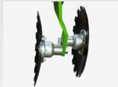
L'unité de disques sur 2 rangées ameublir, émotte et nivelle le lit de semis avant l'implantation de la semence. Avec un angle de 14° sur la rangée de disques avant et de 12° sur la rangée de disques arrière, les disques CombiDisc sont réglés presque à la verticale. Cet angle garantit un nivellement optimal du lit de semence.
