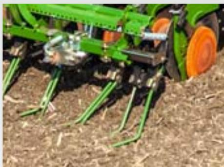
Pour tenir compte des vitesses de semis toujours croissantes, les RoTeC pro intègrent un point d'appui de l'élément extra-robuste. Le recouvreur FlexiDoigts S assure un bon recouvrement de la semence, même dans les conditions d'utilisation les plus dures et avec des volumes de pailles importants.
