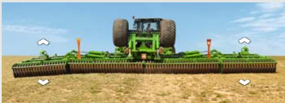
Le Catros+ 12003-2TS est équipé d'un disque crénelé de 510 mm de diamètre, il permet des profondeurs de travail de 5 à 14 cm. Le ContourFrame du Catros+ 12003-2TS est subdivisé en quatre segments, chacun étant fixé flottant. La précontrainte hydraulique permet ainsi une adaptation individuelle aux inégalités du sol pour chacun des 4 segments.
