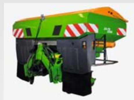
Des bavettes souples sur les ZA-V et ZA-TS évitent la projection de boue sur les disques d'épandage.
