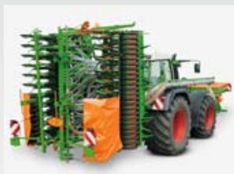
La combinaison de semis avec trémie frontale Avant est disponible en version fixe de 4 m et en version repliable jusqu'à 6 m; elle se replie sur une largeur de 3 m pour les déplacements sur route.
