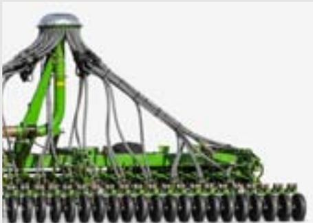
Si le Citan est utilisé sur les terrains secs, une herse de recouvrement Tassaprès HD, avec dents trempées est disponible. Les roulettes de rappui peuvent, indépendamment de l'élément semeur, recevoir une pression jusqu'à 35 kg et assurer ainsi l'homogénéité du sol.
