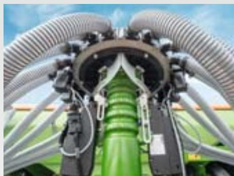
La tête de distribution segmentée est logée derrière la trémie de semence et juste au-dessus des éléments de semis. Le Centaya Super peut aussi être désactivé unilatéralement par le biais de la tête de distribution segmentée, par ex. pour les jalonnages asymétriques en bordure de champ.
