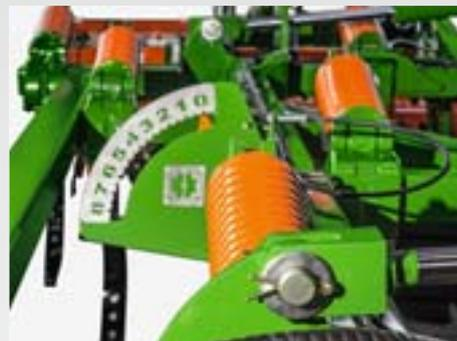
Le réglage hydraulique en option de l'unité de nivellement permet un réglage central depuis la cabine du tracteur. Une échelle graduée bien visible depuis le siège du conducteur permet de visualiser la position actuelle de travail des disques de nivellement.
