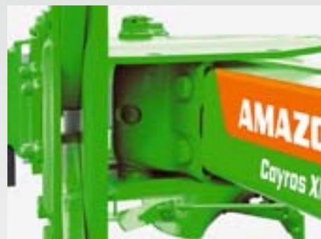
Sur la Cayros V, le réglage de la largeur de travail se fait en continu et hydrauliquement depuis le tracteur. Naturellement le système est très élaboré et permet un réglage simultané, automatique et correct du point de traction et de la largeur de travail.
