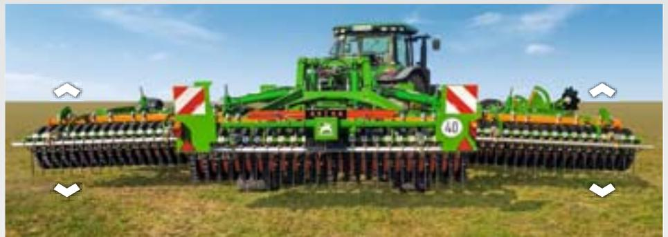
L'adaptation parfaite aux reliefs du sol est renforcée grâce au ContourFrame. Les vérins hydrauliques des segments extérieurs sont précontraints par les accumulateurs hydrauliques à boules d'azote et amenés en position intermédiaire, de ce fait chacun des trois segments bénéficie d'une pression homogène et adaptée aux inégalités du sol vers le haut et vers le bas. Ainsi la machine s'adapte très bien aux reliefs du sol, même sur les terrains vallonnés.
