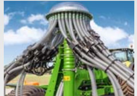
La surveillance des descentes d'alimentation en option est un système d'assistance judicieux qui reconnaît immédiatement les blocages au niveau du soc et de la descente. Des capteurs contrôlent directement derrière la tête de distribution le flux de récolte dans les descentes d'alimentation.
