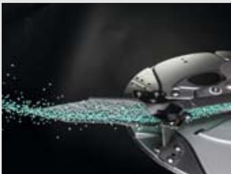
Le système Soft Ballistic pro AMAZONE est intégré en standard sous forme de « pack douceur pour l'engrais » sur les épandeurs portés ZA-TS et les épandeurs traînés ZG-TS. L'organe agitateur, les éléments de dosage et les disques d'épandage sont harmonisés de façon optimale les uns par rapport aux autres.
