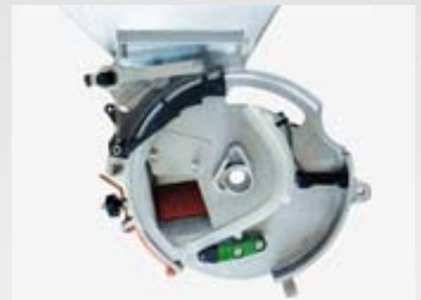
Les semoirs monograine AMAZONE fonctionnent par dépression. La distribution de graines est entraînée mécaniquement (ED Special) ou hydrauliquement (ED Super). Un sélecteur mécanique permet d'agir sur les doubles ou les manques.
