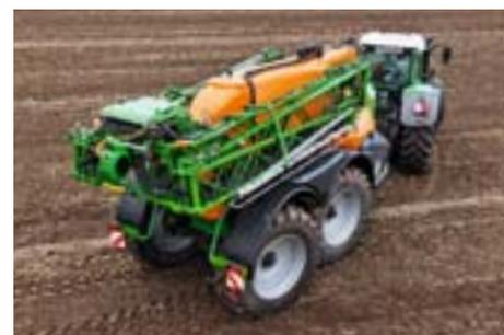
Le suivi de la rampe est en permanence régulier et le confort de conduite optimal, grâce à l'association du timon d'attelage avec suspension, du châssis à suspension hydro-pneumatique et des essieux suiveurs.
