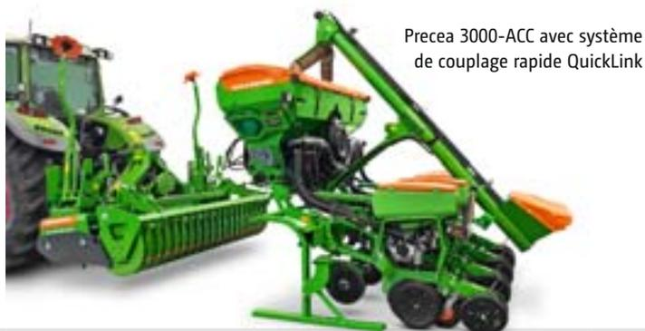
Precea 3000-ACC avec système de couplage rapide QuickLink
