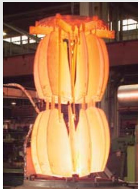
L'une des caractéristiques de qualité particulières des charrues Cayros est le traitement thermique avec le procédé de trempe ©plus pour les versoirs. Ce traitement thermique permet des durées de vie plus élevées, un rendement supérieur, une force de traction moindre et une consommation de carburant réduite.
