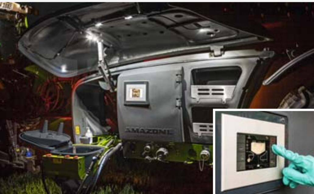
SmartCenter avec éclairage à LED et pack Confort plus
