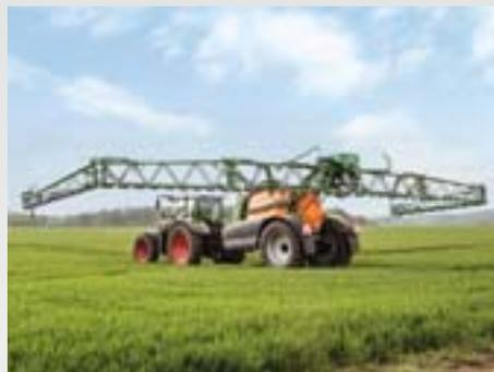
Le pliage Profi ou Flex permet de réaliser simplement et de façon fiable tous les fonctions hydrauliques, y compris le pliage unilatéral, par le biais du terminal ISOBUS depuis la cabine du tracteur.
