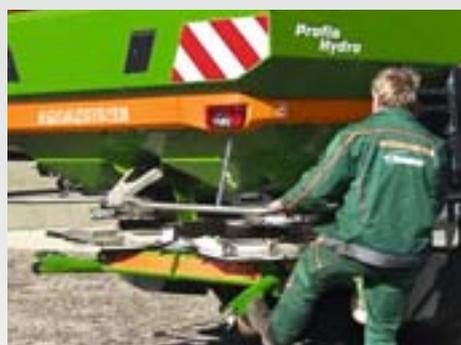
Pour le ZA-V et ZA-TS, les robustes roulettes de manutention facilitent l'attelage et le dételage de l'épandeur, ainsi que les manœuvres dans la cour. Les roulettes sont rapidement repliées et dépliées et protégées des saletés.
