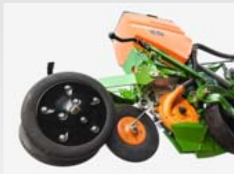
L'élément semeur Contour AMAZONE est parfaitement adapté pour le semis mulch et le semis après labour. La caractéristique principale est une régularité de profondeur optimale grâce à une adaptation au relief du sol par le biais d'un tandem longitudinal.
