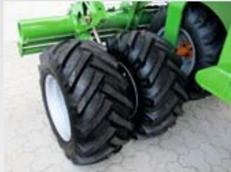
Sur les sites qui ne sont pas trop sensibles aux conditions de germination, le Cirrus peut être équipé de pneus simples AS à structure diagonale. L'autopropulsion est excellente grâce aux barrettes courtes et la machine est également facile à tracter.
