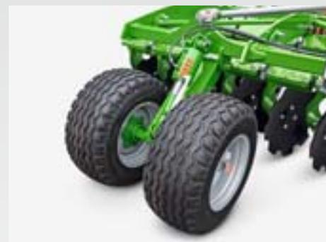
Le réglage de la profondeur de travail se fait en continu et hydrauliquement sur le Certos-2TX par le biais des roues d'appui à l'avant et du rouleau suiveur depuis la cabine du tracteur. L'affichage de la profondeur de travail est bien visible depuis le siège du tracteur et peut être ainsi contrôlé facilement à tout moment.
