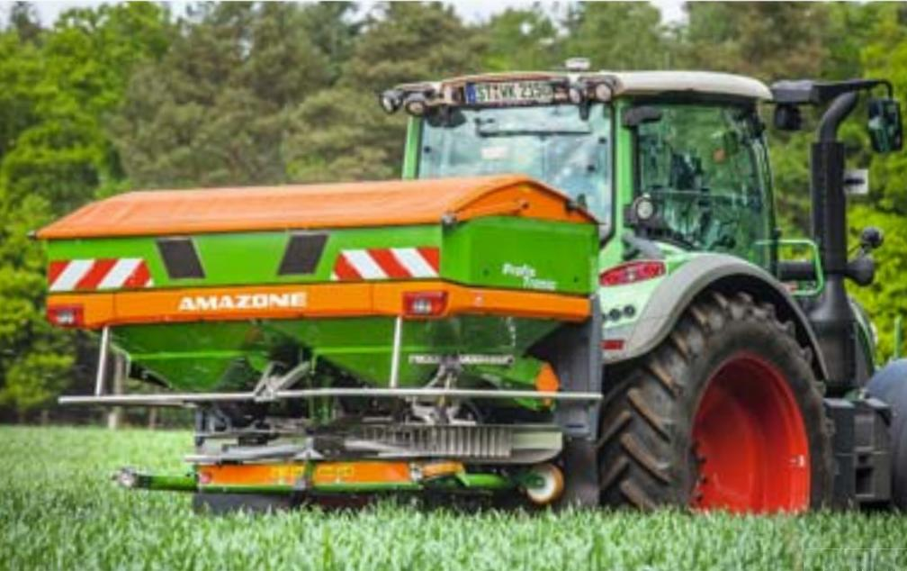
Epandeur à pesée automatique ZA-V 2000 Profis Tronic avec Limiter V<sup>+</sup>
