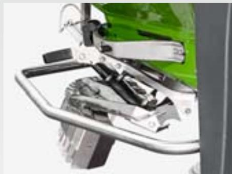
Le ZA-V avec commande hydraulique de trappe est également disponible avec le système d'épandage en bordure à commande hydraulique Limiter V pour l'épandage en bordure, en limite et en fossé. La hauteur recommandée du Limiter V est réglée en insérant l'axe en fonction de la situation avant l'épandage.
