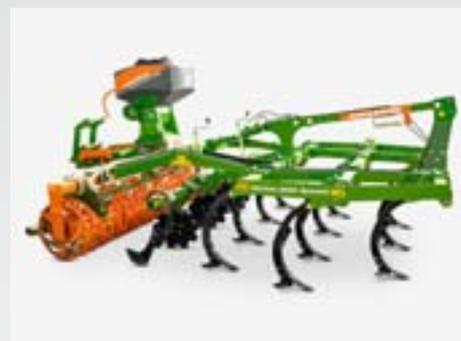
Le semoir GreenDrill compact est disponible en largeurs de travail 3 m, 3,50 m et 4 m. Il est idéal pour le semis d'engrais verts et d'intercultures.
