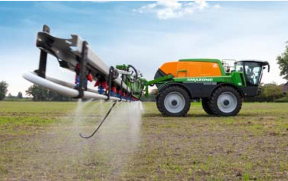
Pulvérisateur automoteur Pantera 4503 avec garde au sol de 1,20 m
