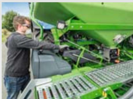
Pour l'égalonnage, le conducteur pousse l'auge d'égalonnage sur un rail sous le carter de distribution et ouvre le clapet d'égalonnage. L'égalonnage peut démarrer en appuyant sur la touche d'égalonnage ou sur le TwinTerminal du SmartCenter.
