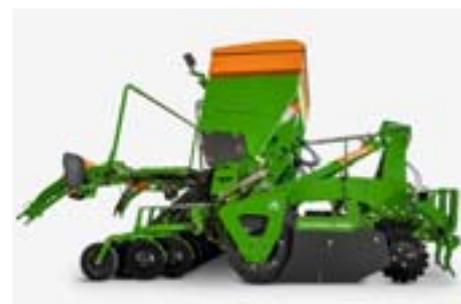
Grâce au système de couplage rapide QuickLink, le CombiDisc est décroché rapidement en quelques manipulations. Le préparateur de sol à disques indépendants porté peut donc aussi être utilisé très facilement seul pour la préparation du lit de semis.
