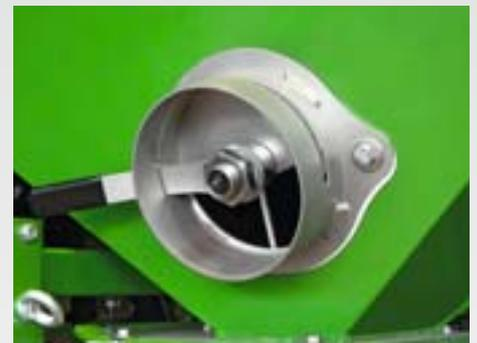
La vidange rapide (option) accessible sur la trémie permet d'évacuer semences et engrais rapidement et simplement. Des tubes HT ou tubes de drainage peuvent être insérés en extension.
