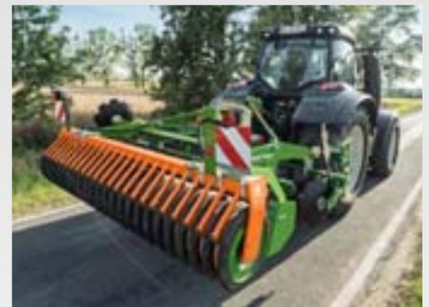
Les nouveaux Catros<sup>XL</sup> sont équipés de disques de bordure réglables individuellement. Sur la variante 3 m et 4 m, ces disques peuvent être repliés facilement pour les déplacements routiers, afin de respecter la largeur respective au transport.
