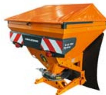
L'épandeur hivernal E+S Hydro 751 est équipé d'une trémie de 750 l avec pointe de cône en acier spécial, d'un entraînement hydraulique des disques d'épandage et d'une régulation de débit en fonction de la vitesse
