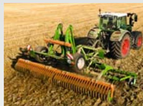
Les machines traînées Catros-2TS en largeur de travail 4 m à 6 m sont équipées d'un train de roulement pivotant avec timon d'attelage. Durant le travail, le train de roulement est pivoté complètement au-dessus du châssis de travail et permet de ce fait une régularité de progression élevée.
