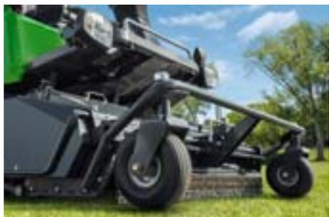
La hauteur de coupe peut être réglée variable de 0 à 90 mm par le biais de l'outil positionné sur l'unité de tonte sur le Profihopper 1500 SmartLine. L'ensemble de l'unité de tonte pivote de manière à ce qu'aucun élément ne détériore le résultat de la tonte.
