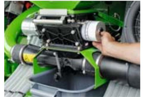
Le système de dosage de l'AD-P Special est entraîné électriquement. L'étalonnage est réalisé en appuyant sur un bouton et le réglage du débit de semis depuis la cabine du tracteur est simple. La bonne accessibilité facilite le remplacement des bobines de dosage et l'opération étalonnage.
