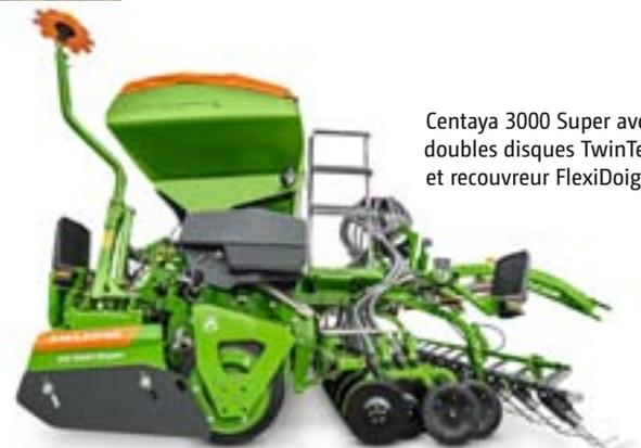
Centaya 3000 Super avec doubles disques TwinTeC et recouvreur FlexiDoigts
