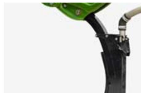
Dent d'application d'engrais avec soc C-Mix 40 pour Cenius-2TX:
