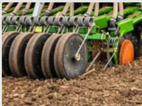
Le recouvreur TassAprès® appuie la terre au-dessus du sillon, afin de générer des conditions de germination optimales. Ce procédé est particulièrement recommandé sur les sols légers, secs pour le semis de cultures de printemps ou de colza.
