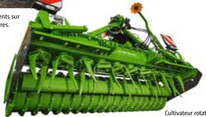
Cultivateur rotatif avec rouleaux à anneaux trapézoïdaux
