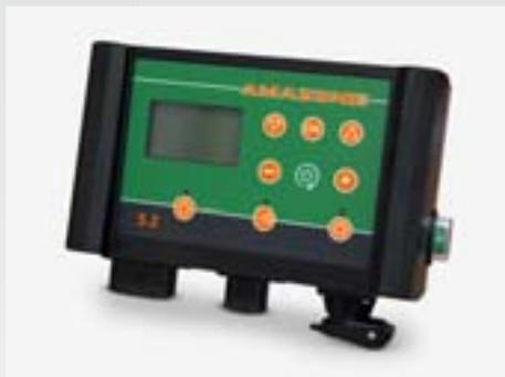
Le terminal du GreenDrill 200 permet de régler l'arbre de distribution et la turbine, ainsi que le régime de l'arbre de distribution. Avec l'équipement confort Control, le terminal permet également de réaliser l'étalonnage et d'afficher la surface réalisée.
