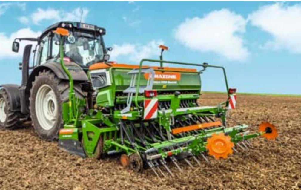
Cataya 3000 Special avec socs RoTeC et recouvreurs FlexiDoigts
