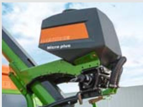
L'ED peut être équipé d'un ou de deux micro-granulateur(s) Micro plus. Il est ainsi possible en un seul passage d'appliquer en fonction du type de machine jusqu'à deux microgranulés lors du semis.
