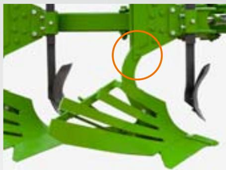
Le boulon de cisaillement représente la solution standard éprouvée pour la sécurité anti-pierre. En cas de sollicitation, le boulon de cisaillement se rompt au niveau du point prévu et le corps de labour s'efface face à l'obstacle en pivotant vers le haut. Ainsi la charrue peut aussi être utilisée sur les sols lourds et durs.
