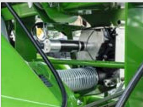
La distribution de la semence est réalisée par le doseur volumétrique entraîné électriquement en-dessous de la trémie de semence. Différentes bobines de dosage sont disponibles pour les semences les plus variées, elles sont remplacées rapidement et facilement.
