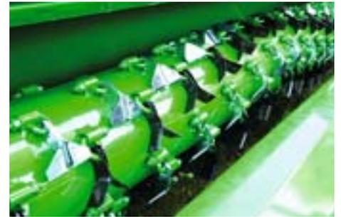
La gamme Tondobalai et Profihopper intègrent le rotor de coupe précise SmartCut doté d'une de ramassage exceptionnelle. Le rotor se caractérise par la disposition spéciale des couteaux en forme de V qui permet une réduction de la consommation d'énergie et du niveau sonore.
