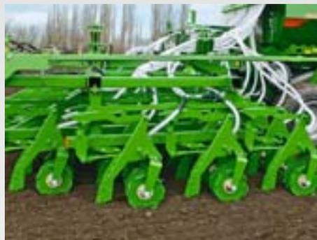
La disposition des unités de socs, sur les 4 rangées successives de traverses longitudinales, assure un écart important entre elles et un bon passage de la paille.
