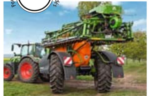
L'UX Super est disponible avec un nouvel essieu directeur offrant un angle de braquage de 28° max. Grâce à son grand rayon de braquage et à sa forme compacte, l'UX Super est en mesure de prendre des virages très serrés. En fonction des pneus et de la largeur de voie, un rayon minimal de courbe de 4,50 m est possible.
