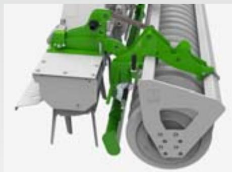
La lame de nivellement nivelle le flux de terre entre les dents et le rouleau et pousse les obstacles vers le bas. La sécurité intégrée permet à la lame de nivellement de s'effacer vers le haut en cas d'obstacles importants.
