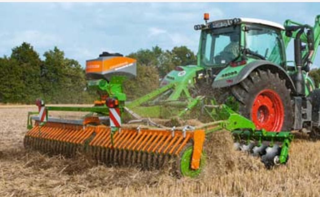
Catros<sup>+</sup> 5002-2 en largeur de travail 5 m avec disques crénelés (diamètre 510 mm)
