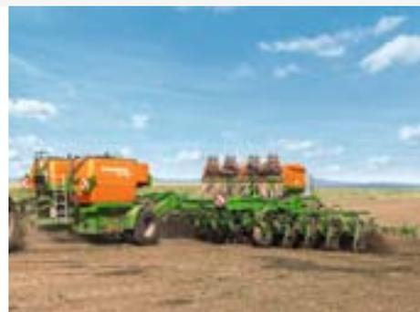
Le semoir Primera DMC, le semoir Condor ou le semoir monograine EDX peut être associé à une unité de fertilisation FDC, spécialement sur les zones de culture arides. Une pompe achemine l'engrais liquide jusqu'aux socs semeurs qui amènent l'engrais dans le sol. Ce combiné est utilisé pour réaliser le semis et la fertilisation initiale en un seul passage.
