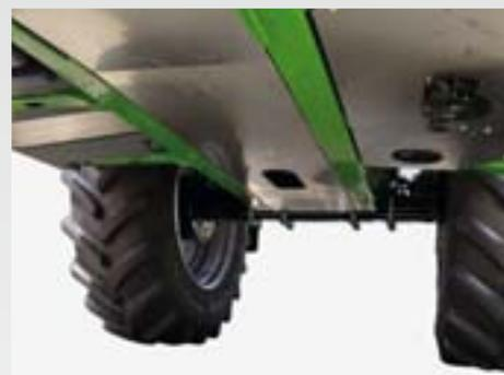
La protection sous châssis de l'UX Super offre, même sur les cultures hautes, une solution optimale pour protéger au mieux la machine et les plantes. La protection sous châssis offre un habillage complet en tôles d'acier spécial, le train de roulement et les plantes sont protégés au mieux.
