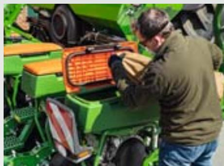
Les trémies de semence ont une capacité de 55 l. Les trémies sous pression s'ouvrent d'une seule main et sont protégées de la poussière par un joint en caoutchouc. Par ailleurs une glissière est intégrée dans le couvercle de trémie pour évacuer la semence restante.
