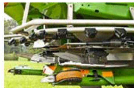
Les épandeurs ZA-TS-peuvent être équipés du système Argus pour la surveillance des zones d'épandage. Argus Twin surveille les zones de projection du côté gauche et du côté droit de l'épandeur grâce aux capteurs et corrige si nécessaire le système d'alimentation, au besoin indépendamment côté par côté.
