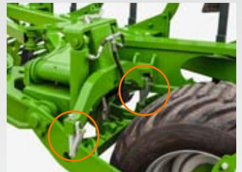
Le réglage de l'inclinaison de la charrue se fait sans outil, séparément pour le côté droit et le côté gauche.
