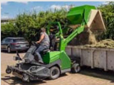
Le design de la benne permet une vidange à une hauteur de 2,10 m (Profihopper 1250 SmartLine) ou 2,50 m (Profihopper 1500 SmartLine). Le point de déchargement a été positionné bien en arrière pour pouvoir charger facilement des conteneurs hauts.
