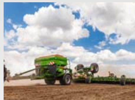
L'XTender-T traîné est particulièrement adapté aux tracteurs sans dispositif de relevage ou disposant de faibles forces de relevage. Le train de roulement permet une charge d'appui de l'outil porté de 4000 kg.
