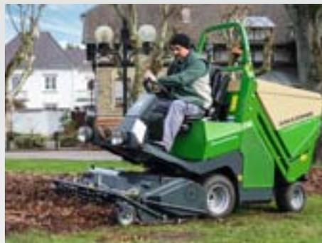
Grâce à une aspiration surpuissante, il aspire presque « tout » (feuilles, glands, châtaignes, etc ...). Le volume de la benne est mis à profit de façon optimale. Les feuilles broyées grâce aux couteaux en rotation se décomposent plus rapidement.
