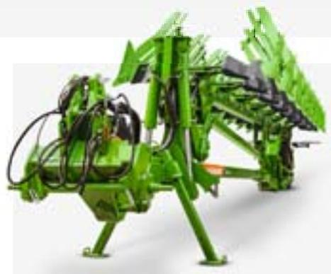
La position de remisage de la charrue Hektor en position de transport est particulièrement pratique. Comme le réglage de l'inclinaison n'a pas d'influence sur la position de l'axe des bras d'attelage inférieurs, l'attelage de la charrue au tracteur est particulièrement confortable. L'axe des bras d'attelage inférieurs est disponible au choix en Cat. 3 ou Cat. 4N.
