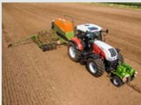
Le rouleau d'essieu intermédiaire T-Pack U en amont passe sur la surface devant l'outil à disques. Ainsi le sol devant la machine est encore une fois rappuyé. C'est un avantage particulièrement intéressant sur les sols légers. Le rouleau tasse avant intermédiaire T-Pack U en amont peut aussi être utilisé seul comme tasse avant tracteur.
