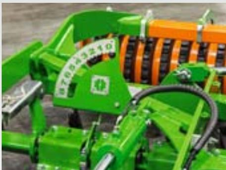
La profondeur de travail à commande hydraulique de série permet un réglage confortable en cabine. De ce fait la profondeur de travail peut être adaptée de façon très souple. Le travail peut être superficiel en plein champs et profond en tournières ou sur les traces.
