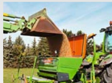
Une passerelle de chargement particulièrement large, accessible par une échelle repliable facilite le remplissage du semoir. L'ouverture de remplissage très généreuse permet un processus de remplissage rapide et facile, également avec Bigbag, chargeur frontal ou semence en sac.
