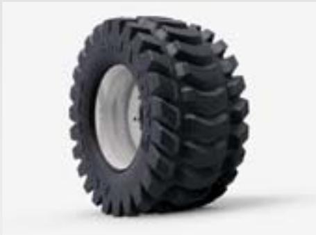
Les pneus Matrix sont le cœur de tous les Cirrus et la garantie de levées homogènes et rapides des champs. L'association d'un diamètre important et d'un nouveau profil assure une excellente autopropulsion – et donc de faibles forces de traction.
