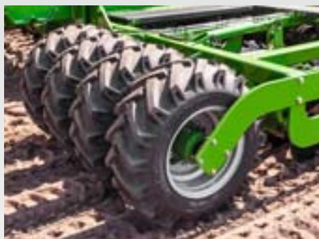
Avec le rouleau latéral T-Pack S pour les Cirrus 4003-2/2C/2CC et 6003-2/2C/2CC, le sol peut être rappuyé dans des conditions faciles à moyennes ou après le labour devant l'outil à disques et assure ainsi un rappuyage supplémentaire.
