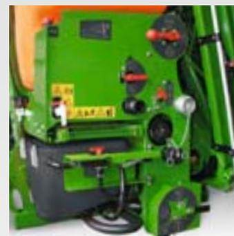
Le tableau de commande de l'UF est positionnée à gauche sur la machine. Seuls trois vannes suffisent à piloter toutes les fonctions.
