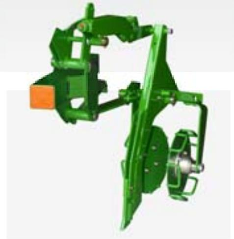
Les socs à pointes, guidés par parallélogramme, sont constamment en mesure de suivre les inégalités du sol. Le système de sécurité anti-pierres assure la possibilité élastique de s'effacer, verticalement et horizontalement en cas d'obstacles.
