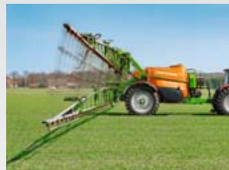
Grâce à sa suspension en forme de parallélogramme, l'UX peut atteindre des hauteurs de pulvérisation de 0,50 à 2,50 m. La position de la rampe au travail est excellente, grâce à une suspension pendulaire 3D ou 4D.
