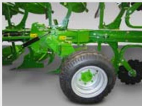
Passage de la position de travail à la position de transport particulièrement confortable grâce au pivotement de la roue combinée.
