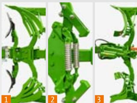
Trois systèmes de sécurité anti-pierre différents sont proposés. Mécanique par boulons de cisaillement (1), semi-automatique par ressorts spirale (2) ou une variante hydraulique entièrement automatique (3).
