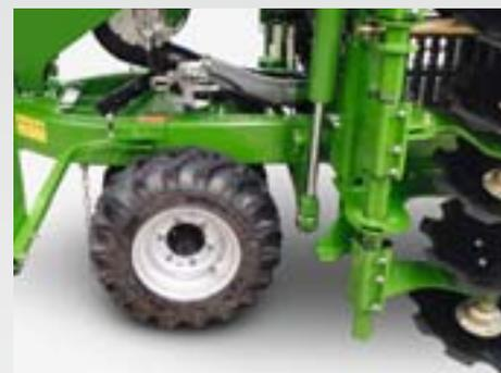
Le concept de rouleau en amont sur les Cirrus 4003-2/2C/2CC et 6003-2/2C/2CC peut être complété par le rouleau T-Pack IN. Celui-ci est monté au centre de la machine en-dessous du timon et rappuie ainsi la voie intermédiaire du tracteur.
