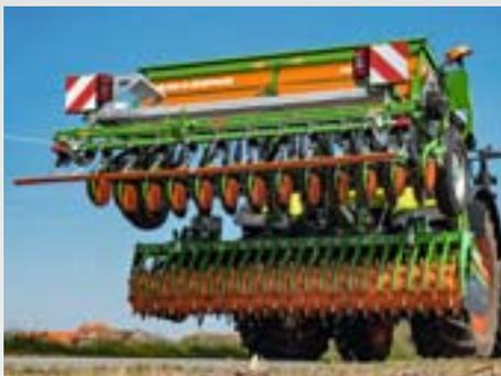
Avec le système Portacourt, le semoir est tiré vers l'avant lors du transport ou en tournière pour réduire la force de traction nécessaire.
