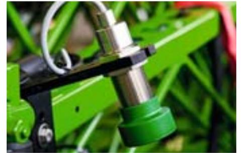
Le suivi de rampe DistanceControl Plus est équipé de quatre capteurs à ultrasons. Outre le nombre supérieur de capteurs, le logiciel de régulation permet un guidage optimal de la rampe, même à des vitesses de déplacement élevées et des hauteurs de travail moindres.
