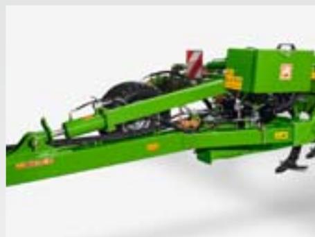
Un système de report de charge est disponible en option. Dès son activation, il transfère une partie du poids de la machine sur l'essieu arrière du tracteur. Jusqu'à 1500 kg supplémentaires sur l'essieu arrière.
