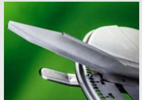
3 paires de disques seulement couvrent l'ensemble de la plage de travail de 10 m à 36 m. La largeur de travail est réglée simplement, rapidement et en toute sécurité en modifiant la position de l'aube d'épandage. Le réglage des aubes se fait sans aucun outil, grâce au système QuickSet.
