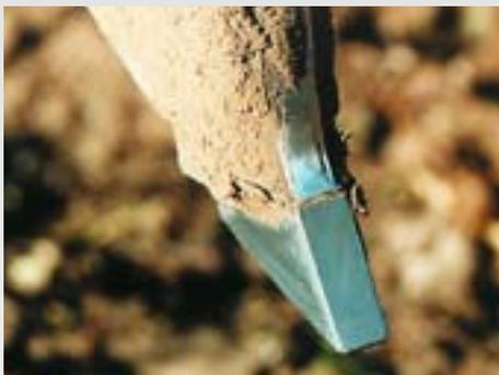
Les socs à couteur, pointés en avant dégagent le sillon de semis pour la semence et l'engrais – éprouvé 100.000 fois !
