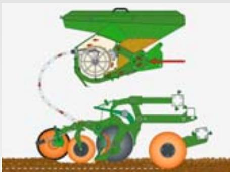
La séparation entre la distribution et les éléments semeurs est cruciale. Positionnée au centre, la sélection pneumatique des graines est opérée par un tambour qui assure la précision de la distribution pour 6 ou 8 rangs
