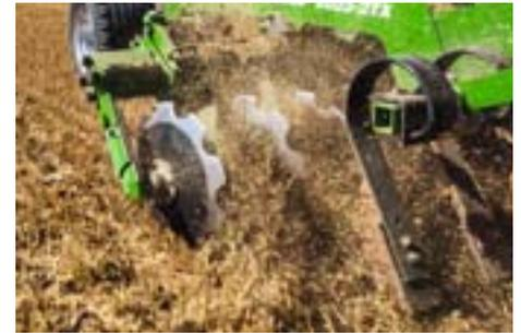
Un Crushboard devant ou derrière les rangées de disques est proposé en option pour niveler et améliorer l'émottage. Il permet de casser les grosses mottes en surface, en particulier après le labour.
