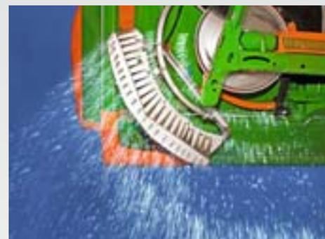
Pour l'épandage en bordure, en limite ou au niveau des fossés avec le dispositif d'épandage en limite Limiter télécommandé hydrauliquement, il n'est pas nécessaire de s'arrêter, ni de descendre du tracteur.
