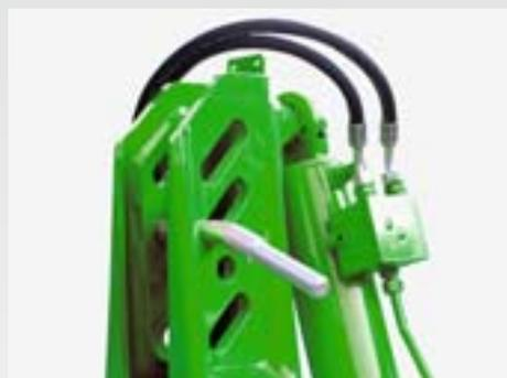
Toutes les têtes d'attelage disposent de trous oblongs pour la fixation du troisième point. Si ce dernier est positionné dans le trou oblong, l'ensemble charrue-tracteur peut s'adapter de façon optimale aux inégalités du sol et maintenir ainsi la profondeur de travail souhaitée.
