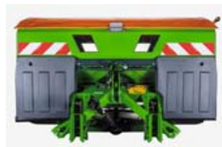
Un châssis robuste et un centre de gravité optimal sont les caractéristiques essentielles du ZA-V. Le châssis Super dispose d'une charge utile de 3 200 kg, le châssis Ultra d'une charge utile de 4 500 kg.
