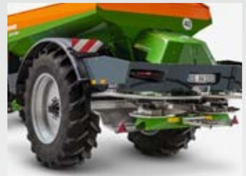
Les pneumatiques grand volume réduisent la pression d'appui au sol et permettent l'utilisation même dans les conditions les plus difficiles. Avec les pneumatiques à profil agraire, les largeurs de voies de 1,80 à 2,25 m sont possibles.
