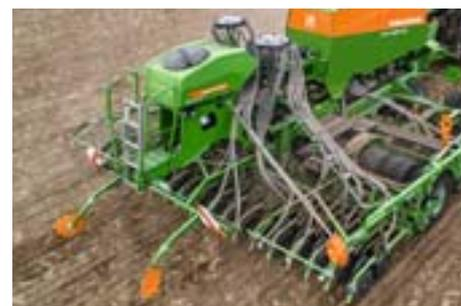
Le semoir compact pneumatique universel GreenDrill pour combiné de semis traîné Cirrus permet à l'utilisateur d'appliquer à la surface du sol durant le semis un autre produit, que cela soit de la semence pour cultures dérobées ou de l'hélicide.
