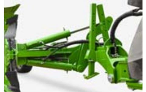
En tant que liaison entre le châssis de la charrue et le dispositif de retournement, le nouveau système de coulissement en rotation garantit une stabilité maximale au retournement et une ligne de traction optimale de l'attelage. Les vérins de retournement avec un amortissement hydraulique des fins de course garantissent un retournement de la charrue linéaire et sans à-coups.
