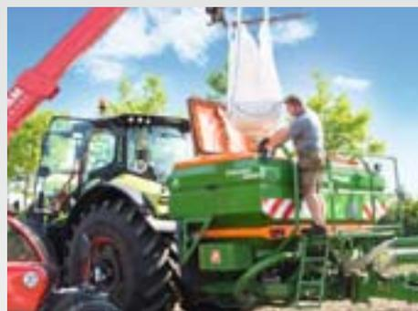
Les XTender sont dotés d'une trémie sous pression offrant une capacité de 2 200 l ou 4 200 l qui peut être compartimentée à 50/50. Il est possible de réaliser des débits de 2 à 400 kg/ha. Le remplissage est rapide et facile grâce à la grande ouverture de trémie.
