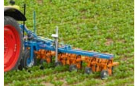
La technique précise de caméras et de commande génère une énorme augmentation du rendement. Les écarts de rangs sont reconnus par la caméra dès 12,5 cm. La technique de caméras permet aujourd'hui des vitesses d'avancement jusqu'à 15 km/h sans aucun problème.
