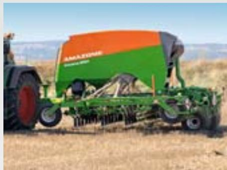
Grâce à un châssis intégré dans l'attelage par bras inférieurs et à son repliage hydraulique, le Cayena impressionne pour sa compacité et sa maniabilité.
