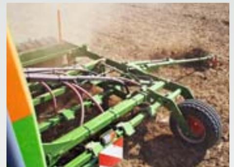
La trémie de semence du Cayena peut contenir 3600 l tout en étant compacte. La visibilité sur les socs TineTeC est ainsi optimale durant le travail. L'ouverture sur toute la surface de la trémie permet un remplissage simple et rapide.
