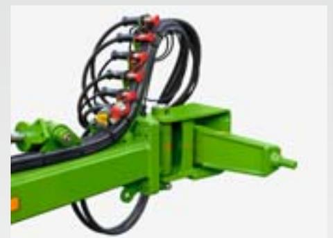
Le Cenius-2TX peut être attelé au tracteur par le biais des bras d'attelage inférieurs, d'une barre oscillante ou d'un attelage boule K80. Cette flexibilité permet d'utiliser des tracteurs standards, à chenilles ou articulés.
