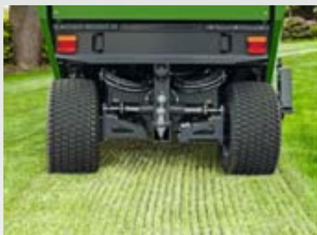
La Profihopper permet une verticoupe parfaite. Les couteaux de verticoupe à montage rapide sans outil incisent la couche superficielle du sol et aèrent la surface herbeuse. Le feutre est enlevé, ramassé et le sol est simultanément roulé.
