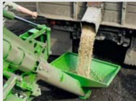
Pour remplir de semences et d'engrais la trémie du Primera DMC, AMAZONE propose une vis de remplissage entraînée hydrauliquement. Les temps de chargement sont ainsi réduits à 15 minutes et le rendement de la machine est encore augmenté en conséquence.
