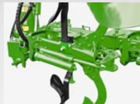
La sécurité anti-pierre NonStop hydraulique est dotée par principe, sur chaque corps de labour, d'un vérin hydraulique avec accumulateur relié. Après avoir franchi un obstacle, le corps de labour est de nouveau amené automatiquement sur sa position initiale.
