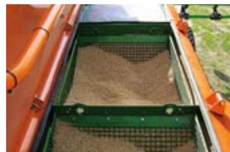
Trémie sous pression d'une capacité de 8000 l, divisée en 2 compartiments (2/3 semence + 1/3 engrais). Cette méthode permet de réaliser lors du semis de céréales d'hiver un apport initial adapté, ou pour les cultures de printemps dans des conditions continentales une fertilisation complète optimale sans perte, directement dans le sol.
