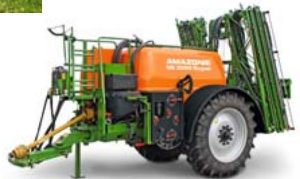
Pulvérisateur traîné UG 3000 Super avec rampe Super-S2 de 15 m à 28 m
