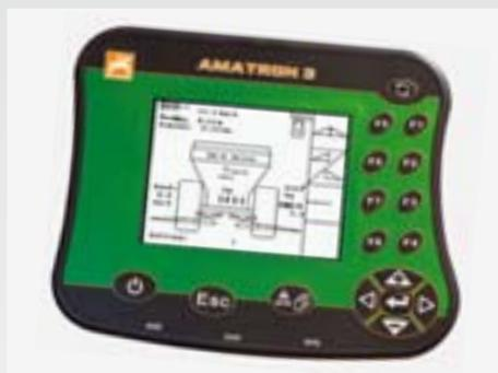
ZG-B Drive est doté d'une régulation de débit en fonction de la vitesse par le biais d'un convoyeur à régulation électro-hydraulique avec l'AmaTron 3.
