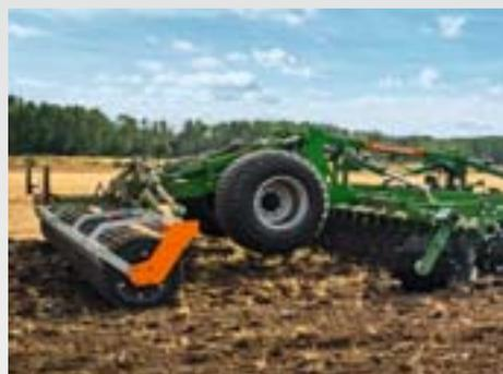
Le train de roulement central intégré confère au Certos-2TX une maniabilité élevée. Afin d'obtenir une régularité de fonctionnement élevée et une qualité de travail homogène, le Certos-2TX est équipé de série d'un amortissement au niveau du timon.
