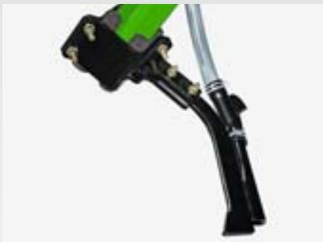
Le soc TineTeC forme un sillon de semis net et propre, exempt de masses organiques. Le mode de construction extrêmement étroit permet de déplacer moins de terre. Avantages : économie d'eau, puissance de traction de la machine minimisée.
