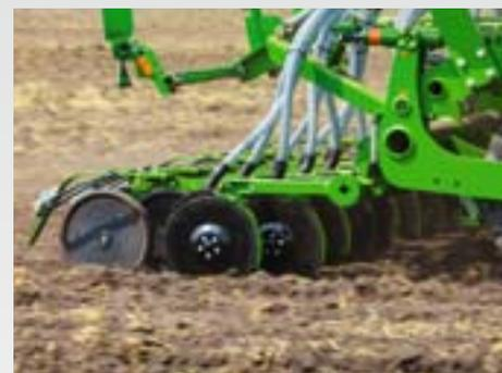
Le système doubles disques TwinTeC+ est doté d'un réglage hydraulique en continu de la pression d'enterrage qui comprend une large plage de réglage de 15 à 100 kg. De ce fait la pression est adaptée rapidement et simplement en fonction des variations des conditions de sol.
