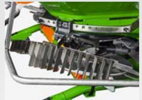
Pour épandre sur les champs en limite de routes ou de points d'eau, le ZA-V peut aussi être équipé en option de la commande électrique Limiter V<sup>+</sup>. Le dispositif d'épandage en limite peut ensuite être descendu de façon précise dans le flux d'engrais.
