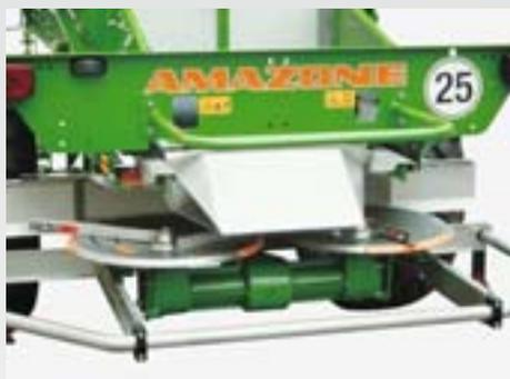
Le ZG-B dispose d'un organe d'épandage universel pour épandre les produits humides (chaux) jusqu'à une largeur de 15 m et les engrais minéraux jusqu'à une largeur de 36 m.
