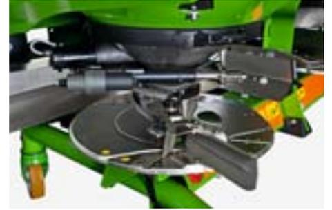
Le système d'alimentation avec l'organe agitateur étoilé, entraîné électriquement, logé dans les cônes de descente, assure un flux d'engrais régulier sur le disque d'épandage. Les segments en forme d'étoile à rotation lente de l'organe agitateur acheminent l'engrais de façon homogène vers leur trappe respective.
