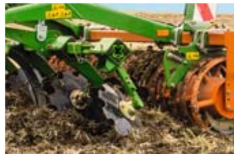
Disques de nivellement crantés de 460 mm pour une utilisation également avec des volumes de paille élevés. Effet d'incorporation supérieur par rapport aux disques lisses, l'entraînement est assuré en permanence.
