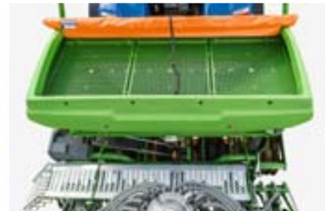
L'ouverture large de la trémie est de 2,43 m x 0,91 m, le Centaya peut donc être facilement rempli avec un Bigbag ou un chargeur frontal. Pour un remplissage par des sacs, les grilles de la trémie sont utilisées comme support de réception.
