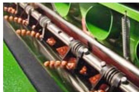
De série, le réglage des sélecteurs est électrique et piloté depuis l'AmaTron 3 en cabine. Le bon réglage des sélecteurs rend impossible la présence de tous doubles ou manques sur la ligne de semis.
