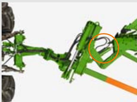
Le réglage hydraulique, fourni de série, de la prise de raie du premier corps modifie la largeur de travail du premier corps de labour et l'adapte la cote interne de voie du tracteur. Le raccord de raie est ainsi optimal et ce système est particulièrement pratique sur les sols hétérogènes ou en utilisant des tracteurs différents.
