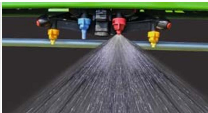
Coupure électrique individuelle des buses AmaSelect avec buses quadrijets et écart des buses 50 cm ou 25 cm
