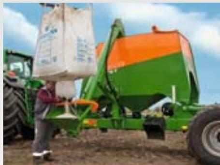
Grâce aux grandes ouvertures, les trémies sont facilement et directement remplies avec un chargeur frontal. Sur demande, les machines peuvent aussi être équipées d'une vis de remplissage.
