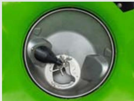
Les organes agitateurs en étoile entraînés électriquement dans les pointes de cônes sur les épandeurs TS assurent un flux d'engrais homogène sur le disque d'épandage. Ils se déconnectent automatiquement, dès que le tiroir de fermeture est fermé, même unilatéralement ou indépendamment l'un de l'autre.
