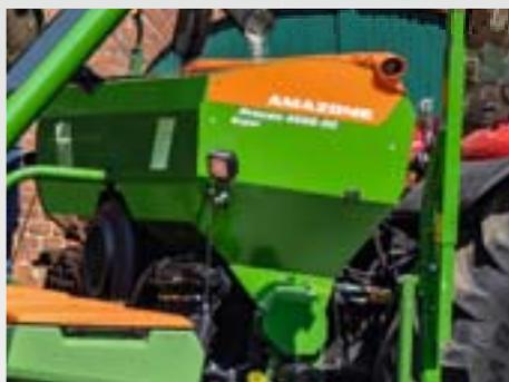
En fonction du type de produit et de l'équipement, la trémie d'engrais peut afficher une contenance de 950 l ou 1250 l. Le semoir monograinne Precea-CC peut être combiné avec la fertilisation localisée en procédé Double-Shoot.
