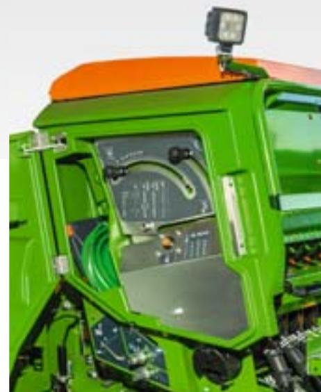
Pour faciliter encore l'utilisation, AMAZONE propose avec le SmartCenter un positionnement très simple et clair des réglages les plus importants. Le système de distribution électrique est réglé et étalonné très rapidement de façon centrale depuis la gauche.
