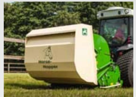
La verticoupe et la fauche du pré pour chevaux avec ramassage simultané de l'herbe et des crottins empêche la formation de refus et la prolifération de parasites.
