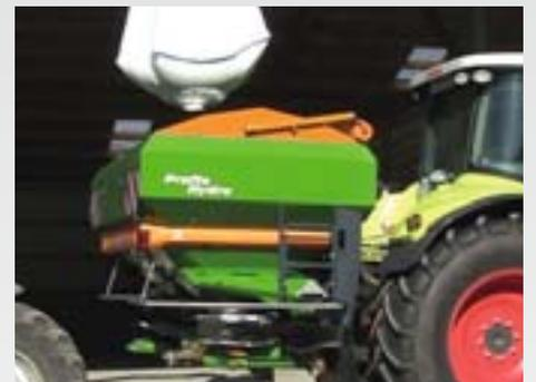
La bache enroulable à commande hydraulique vous permet sur les ZA-V et ZA-TS de continuer à épandre, même lorsque les conditions météorologiques sont mauvaises.
