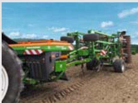
XTender offre un attelage au tracteur sur le centre de gravité par le biais de l'attelage 3 points (cat. 3/4N). Le couplage au XTender de la machine en aval est réalisé également par le biais des bras inférieurs de catégorie 3 ou 4N.
