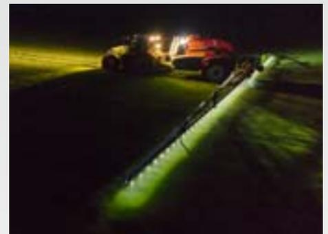
L'éclairage à LED individuel des buses en option amène l'éclairage de façon encore plus ciblée sur le cône de pulvérisation. De façon absolument homogène, le fonctionnement de la dernière buse de la rampe peut aussi être évalué facilement.
