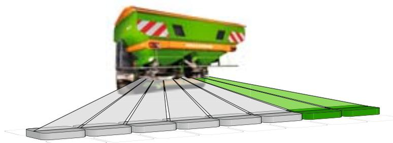
Avec une coupure de 8 ou 16 tronçons pour le ZA-V il est possible de piloter les tronçons extérieurs
