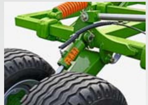
Le réglage hydraulique de profondeur, réglable en continu en option permet de modifier la profondeur de travail également durant le déplacement. Il est ainsi possible de réagir de façon souple en fonction des différentes conditions du sol et des conditions d'utilisation.
