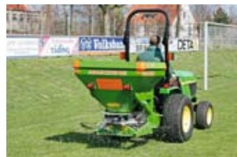
En peu de temps et quelques manipulations seulement, l'épandeur hivernal E+S se transforme en épandeur d'engrais pour granulés d'engrais. Il permet d'obtenir une très bonne répartition transversale et longitudinale et des rendements élevés.
