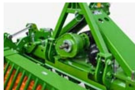
La transmission de la prise de force permet d'entraîner un outil porté, par exemple un semoir pneumatique.
