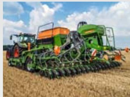
Le GreenDrill 501 avec une capacité de trémie de 500 l sert au semis d'intercultures, de semences fines graines, de cultures dérobées et d'engrais, associé à la préparation du sol traînée AMAZONE ou au semoir rapide Cirrus.
