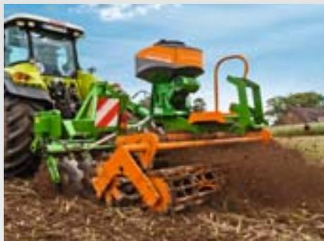
L'arbre de distribution est logé dans la zone de dosage, en-dessous de la trémie, en fonction des caractéristiques de la semence et des débits il est équipé de bobines normales ou fines graines. L'entraînement de l'arbre de distribution est assuré par un moteur électrique ou hydrauliquement.
