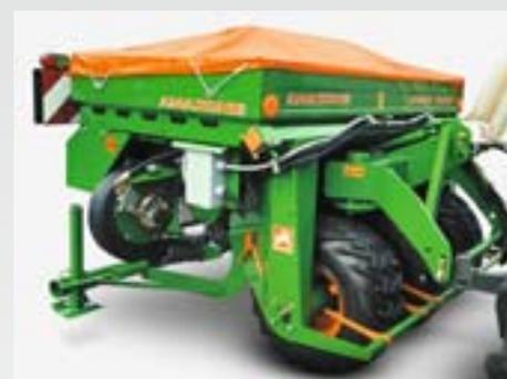
La turbine destinée à convoyer la semence est entraînée par un moteur hydraulique.
