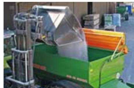
Les pneumatiques, largement dimensionnés, réduisent la pression exercée au sol. La trémie est facile à remplir, via le silo ou le chargeur.
