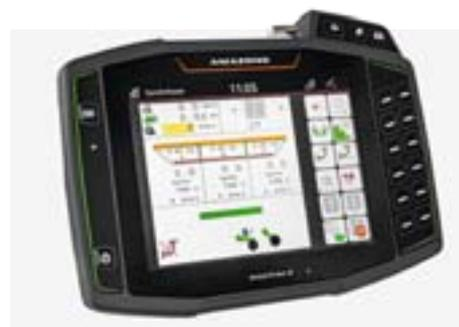
La commande machine du GreenDrill 501 peut se faire de différentes manières. Si le GreenDrill 501 est monté sur un Cirrus, il est totalement intégré dans l'électronique du Cirrus. Si le GreenDrill est monté sur une préparation du sol, il est doté de son propre ordinateur ISOBUS et peut être piloté, soit par le terminal ISOBUS du tracteur, soit par le terminal ISOBUS AmaTron 4.
