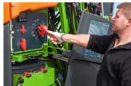
Le poste de pilotage SmartCenter est équipé d'une grande porte pivotante qui protège tous les éléments de commande importants, ainsi que le bac incorporateur de la saleté et des projections des roues. Un support pour les gants et un gobelet doseur est rangé côté intérieur de la porte pivotante.
