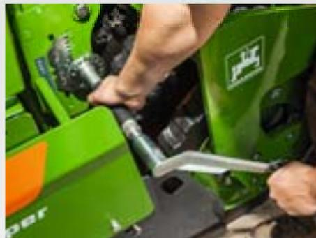
Le nouvel outil de réglage universel du Cataya est la solution idéale qui évite de transporter et de chercher plusieurs outils. Grâce à sa forme ergonomique et à la disposition de tous les points de réglage, chaque réglage peut être modifié en un clin d'œil.
