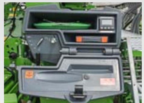
Le SmartCenter positionné du côté gauche de la machine permet d'étalonner et de régler confortablement le Centaya Super et de positionner debout à côté de la machine. La balance numérique et un seau pliant sont rangés dans une caisse de transport directement sur la machine.
