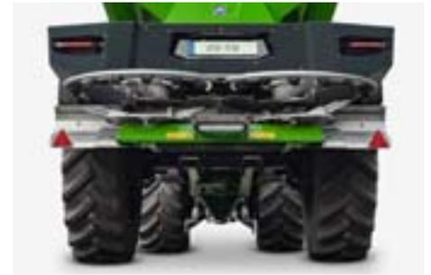
Les tôles réalisées en acier spécial résistent à la forte friction de l'engrais. L'épandeur grande culture ZG-TS intègre un entraînement mécanique des disques d'épandage, le ZG-TS Hydro un entraînement hydraulique des disques d'épandage.
