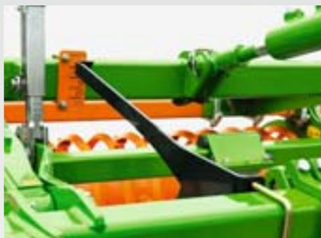
Le réglage en profondeur est réalisé de série mécaniquement, par le biais d'un tirant supérieur, ou hydrauliquement très confortablement depuis la cabine du tracteur. Il est ainsi possible de moduler la profondeur en cours de travail suivants les différentes conditions du sol.
