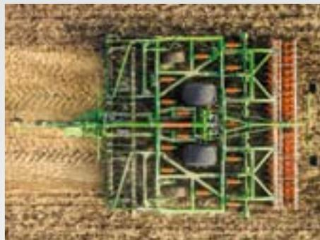
Le compartiment de dents qui suit permet un ameublissement des couches profondes du sol jusqu'à 30 cm. La préparation peut cependant aussi être superficielle, de sorte que la pointe de soc, dans des conditions humides et lourdes, progresse juste en-dessous de la profondeur de travail du déchaumeur à disques.
