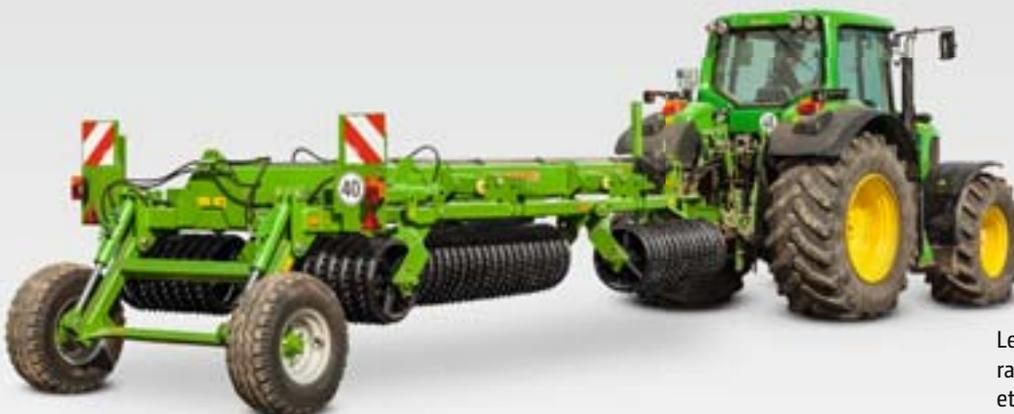
Le rouleau est parfaitement adapté au rappuyage après le semis sur sols lourds et légers. C'est particulièrement important si aucun organe optimal de rappuyage n'a été mis en œuvre.
