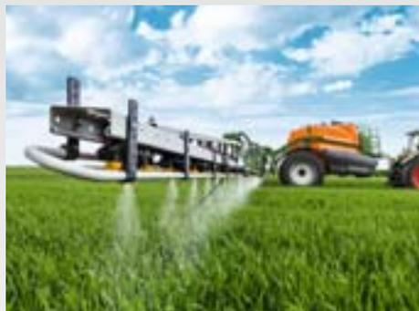
Les rampes AMAZONE sont à la fois super légères et super robustes grâce à leur mode de construction spécial. Les largeurs de travail de la rampe de 21 à 40 m permettent de s'adapter au mieux à la structure de l'exploitation.
