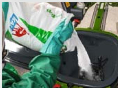
Pour incorporer de façon efficace les produits sous forme de poudre et de granulés, une buse incorporatrice supplémentaire est logée en-dessous de l'ouverture d'aspiration, elle empêche efficacement les bouchages au niveau de l'ouverture d'aspiration. La puissance de cette buse incorporatrice est réglable en continu.
