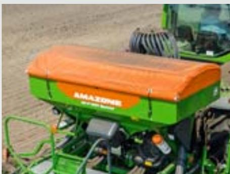
La bache repliable, facile à manipuler, ferme la trémie de semence étanche à la poussière et à la pluie.
